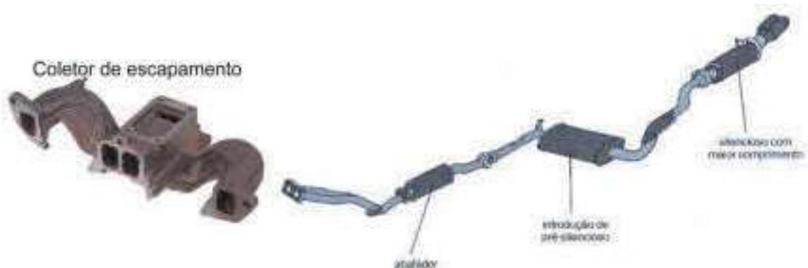
Figuras 137 e 138 - Componentes do sistema de escapamento
