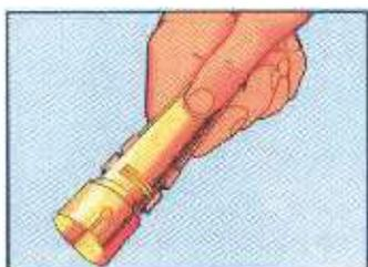
Para conectar os cabos de ignição nas velas, distribuidor ou bobina, pressione os terminais, a fim de obter um perfeito encaixe.
