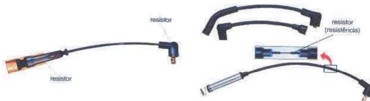
Figuras 179 e 180 - Tipos de cabos de vela
