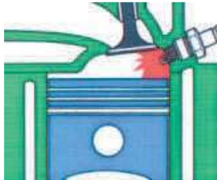
Figura 172 - Propagação da centelha
