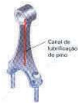
Figura 55 – Canal interno da biela
