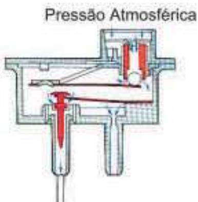
Figura 117 - Válvula sem vácuo
