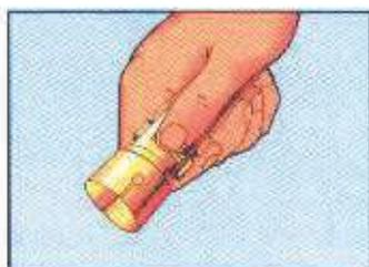
Para retirar os cabos de ignição, puxe-os pelos terminais.
