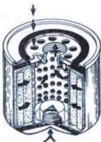
partir daí, passa pelo elemento filtrante, onde as partículas de sujeira ficam retidas. O óleo sai do filtro pela parte central e vai para as galerias lubrificar os componentes móveis do motor. O elemento filtrante é fabricado com papel impregnado de resina ou com tela.
