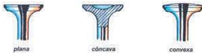
Figura 42 – Tipos de válvulas
