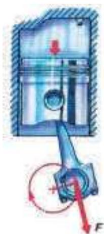
O torque de um motor de combustão interna corresponde ao produto da força que o êmbolo aplica, através da biela, sobre o braço da manivela da árvore de manivelas.
